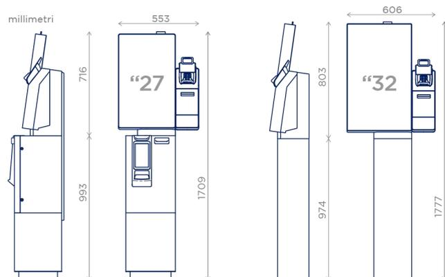
**Visual Pay 27/32** è un sistema modulare e versatile che permette al retail di **configurare la propria soluzione Kiosk** da installare nel proprio negozio e da mettere a disposizione dei clienti, i quali, potranno comodamente scegliere, ordinare e pagare direttamente tramite Visual Pay.
